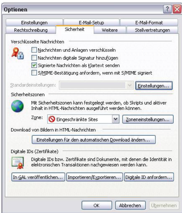
24 Auf der Karteikarte „Sicherheit“ wird angehakt, ob man digital signieren und/oder verschlüsseln will.
