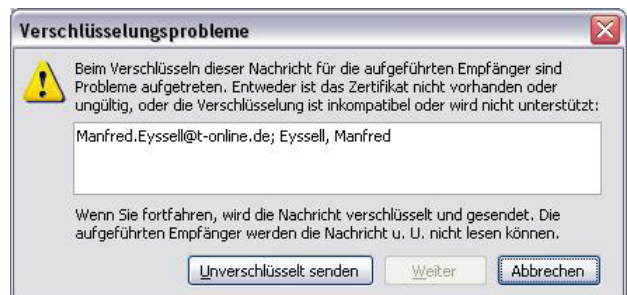
46 Fehlermeldung, wenn eine E-Mail nicht verschlüsselt werden kann, weil der öffentliche Schlüssel des Absenders nicht vorliegt
