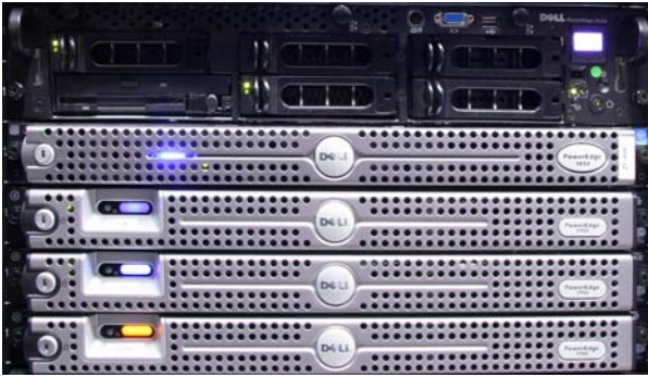
Abb. 1: Dell Rack-Server, von oben nach unten: PE 2650 (ohne Frontabdeckung), PE 1850 und 3 x PE 1650
