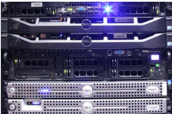
Abb. 2: Dell Rack-Server, von oben nach unten: PE 1850, PE R410 (2 x), PE 2650 und PE 1850, PE 1950
