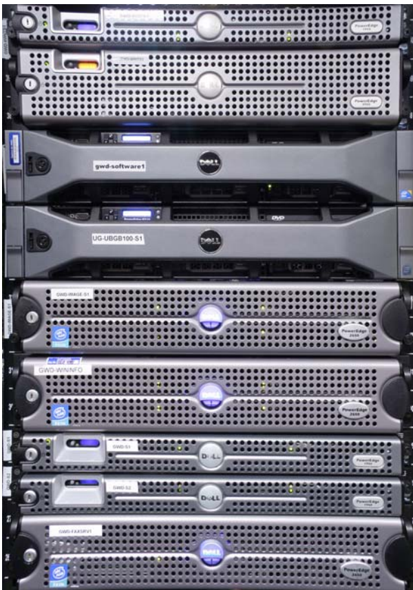
Abb. 7: Einige Server des Active Directory, von oben nach unten: „GWD-WinTS1“ (PE 1950), „GWD-WinTS2“ (PE 2950), „GWD-Software1“ (PE D710), „UG-UBGB100-S1“ (PE D710), „GWD-Image-S1“ (PE 2650), „GWD-WININFO“ (PE 2650), „GWD-S1“ (PE 1950), „GWD-S2“ (PE 1950), „GWD-FAXSRV1“ (PE 2650)
