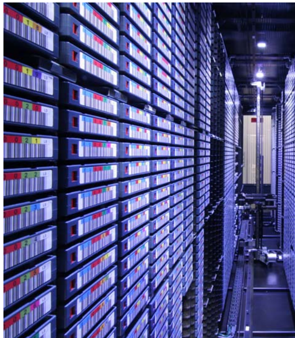
Abb. 6: LTO-3-Bandroboter „adic Scalar 10K“, Blick ins Innere
