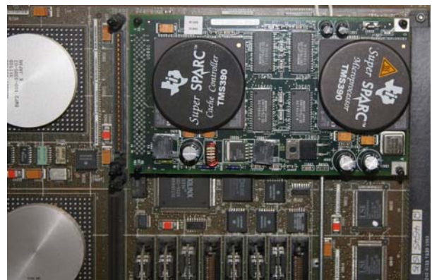
Abb. 3: Ausschnitt der CPU-Platine der Sun SPARCstation 10 mit zwei Mikroprozessoren SuperSPARC TMS 390 auf „Daughterboard“
