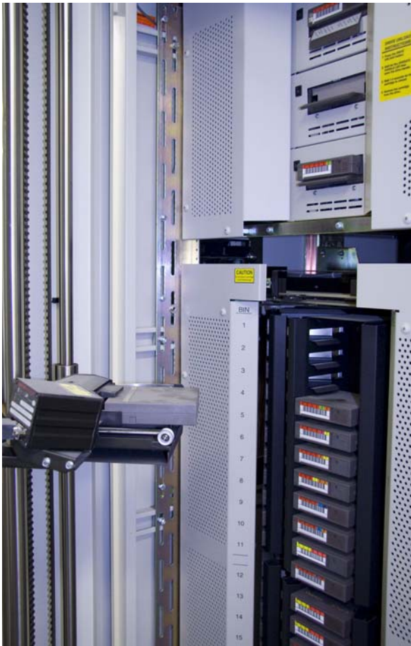
Abb. 12: Einblick in den Bandroboter Digital TL820, rechts oben drei Laufwerke, links der Roboter-Greifer mit Strichcode-Leser
