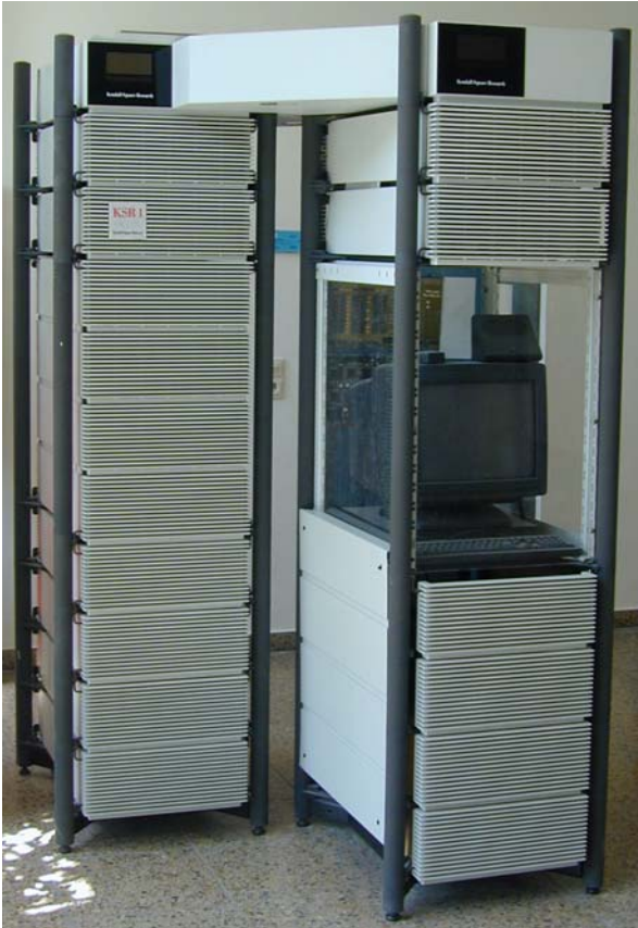
Abb. 15: Die KSR1 im Rechnermuseum der GWDG, im zur Vitrine umgebauten rechten Turm die Bedienungsworkstation „NeXTstation TurboColor“
